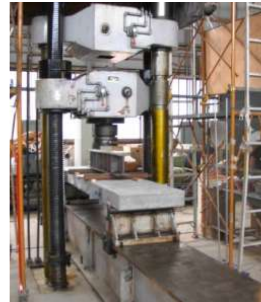
画1 载荷試験状況
